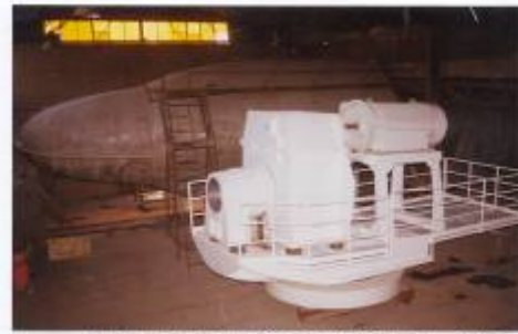
نمای داخلی کابین توربین بادی ۶۰۰ کیلوواتی
